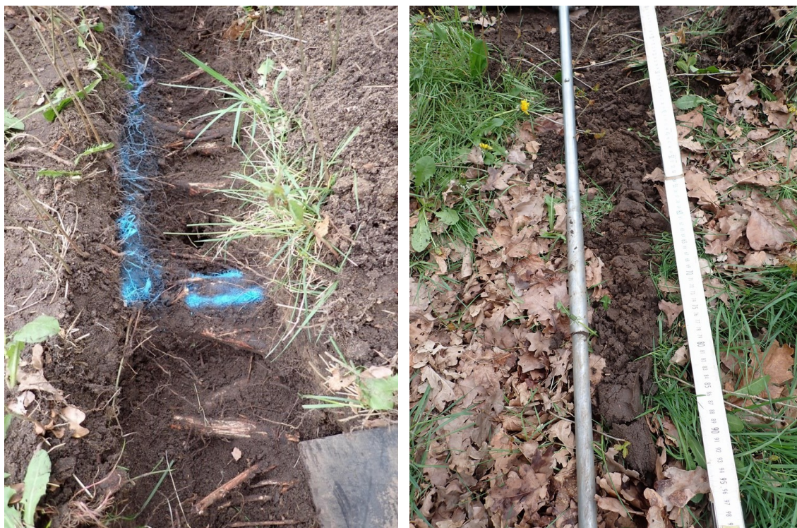
Figuur 7: Proefsleuf op 3 meter ten zuiden van boom 22, met fijne en middelfijne beworteling (links) en het bodemprofiel tussen 70 en 100 cm onder het maaiveld (rechts).
