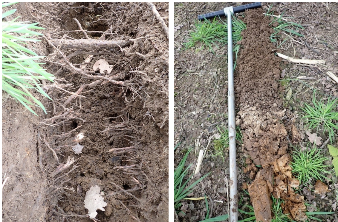
Figuur 6: Proefsleuf op 2,5 meter afstand ten noordoosten van boom 12, met intensieve fijne beworteling (links) en het bodemprofiel op 5 meter afstand ten noordoosten van boom 12 (rechts).
