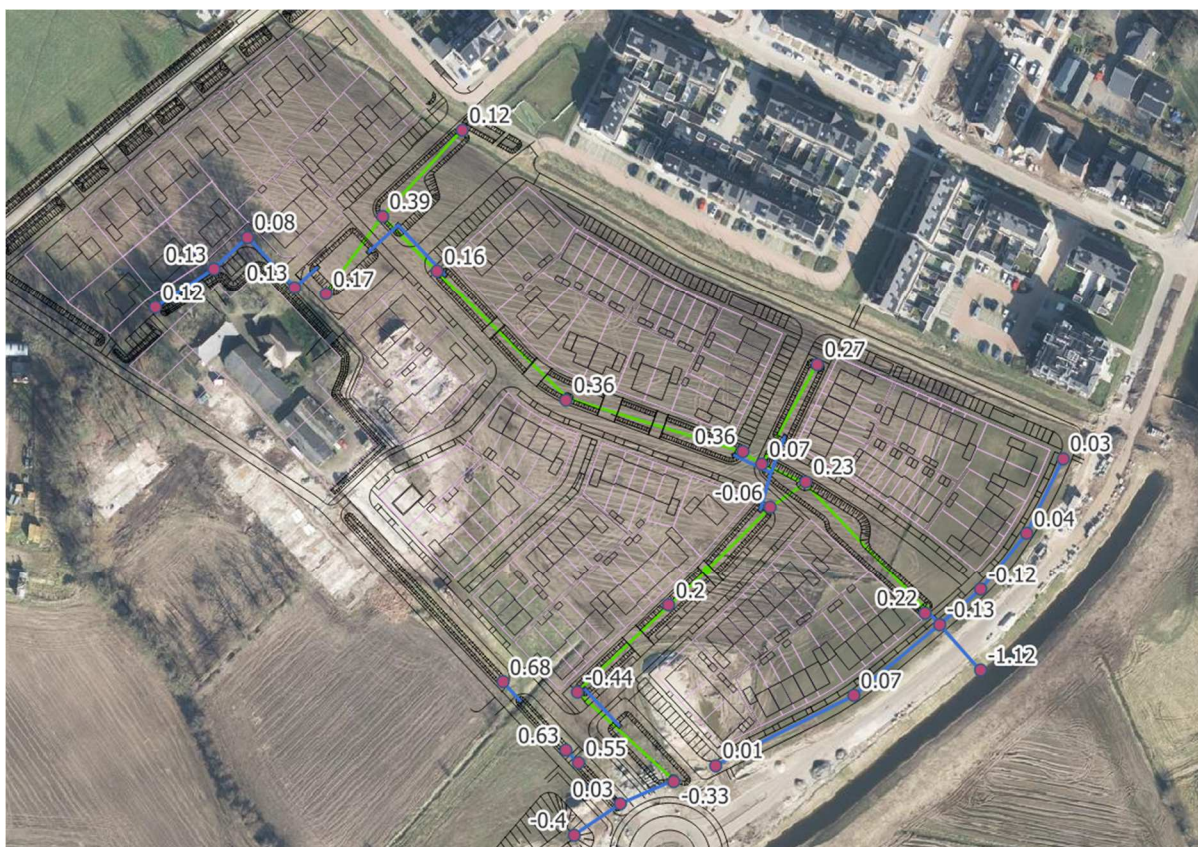
Figuur 4 - Resultaten Stresstest 160 mm; stijghoogte in meter t.o.v. bovenkant putdeksel DT-stelsel en bovenkant putdeksel HWA riolering
