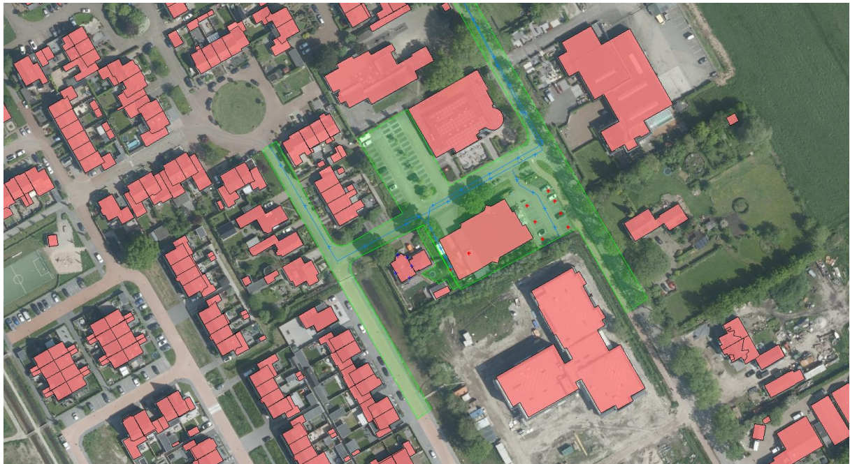
Figuur 3. Overzicht rekenmodel met de verschillende geluidbronnen
