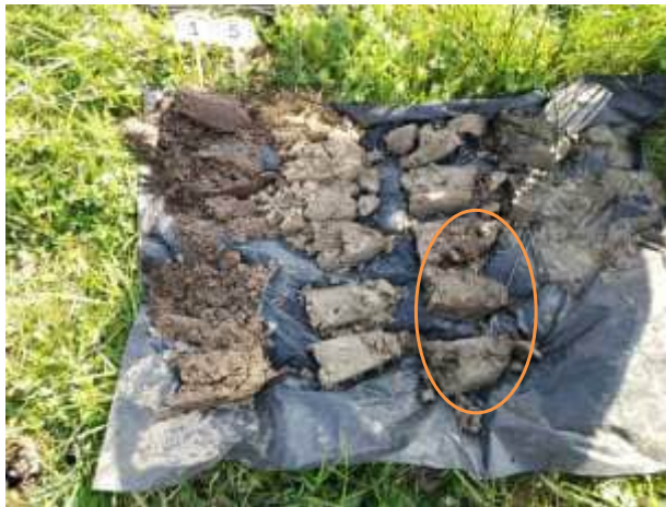
Figuur 29: Boorlocatie 15 in het perceel ten oosten van de Blankenhoefseweg. Een beekerdgrond met op 1 m diepte een ca. 30 cm dikke leemlaag (oranje omlijnd) (watersysteemanalyse, Bosgroepen in voorbereiding).
