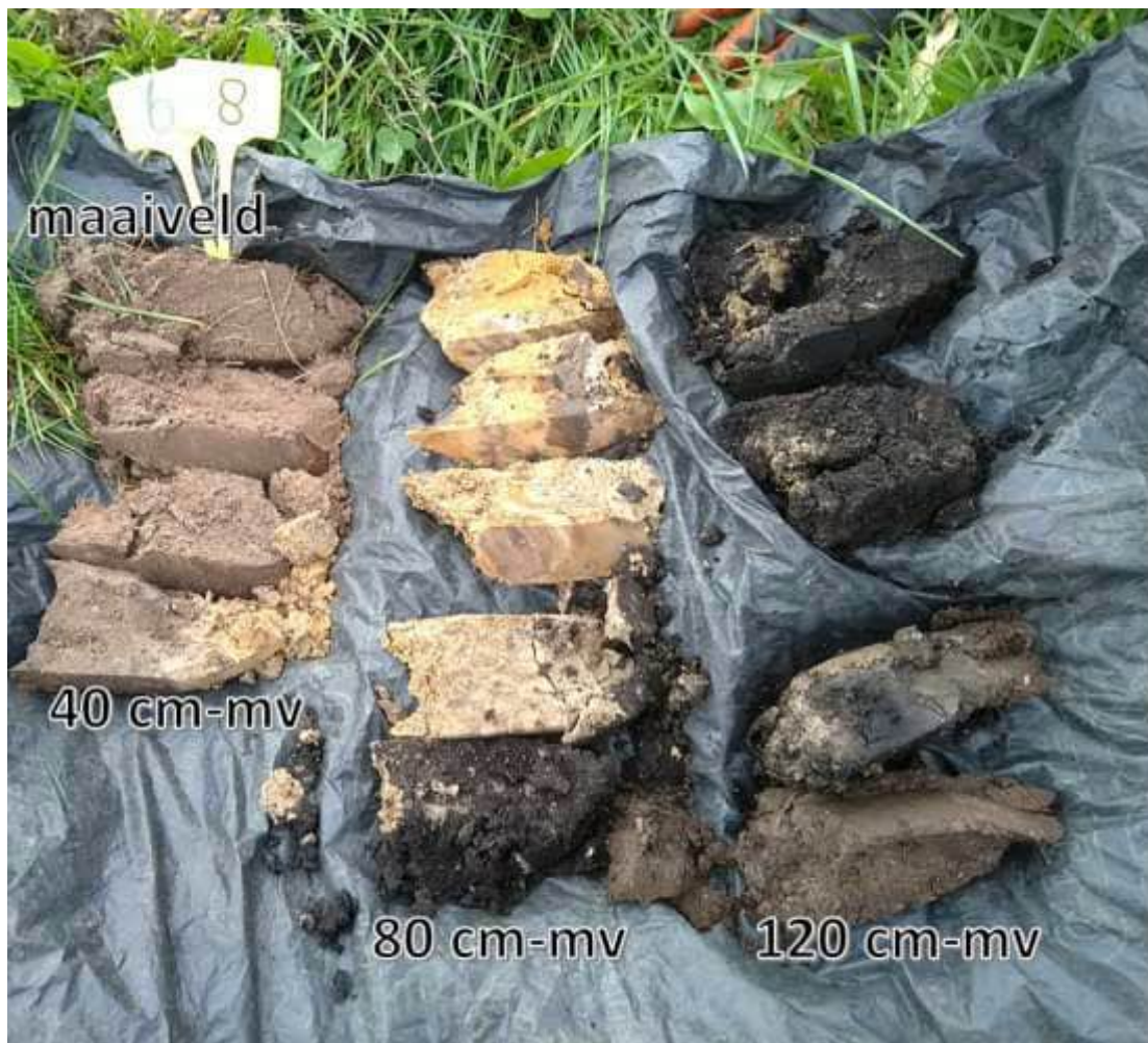
Figuur 7: Voorbeeld van een oorspronkelijke veenbodem in deelgebied oost met ca. 70 cm opgebracht zand. Om hier elzenbroekbos te kunnen realiseren, is het naast het uitvoeren van hydrologische herstelmaatregelen, noodzakelijk om 70 cm af te graven.
