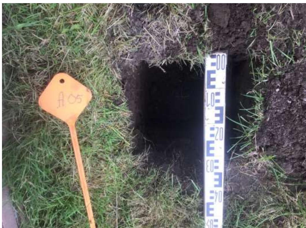
Foto 22: inspectiegat A05 0,2-0,5 m-mv
