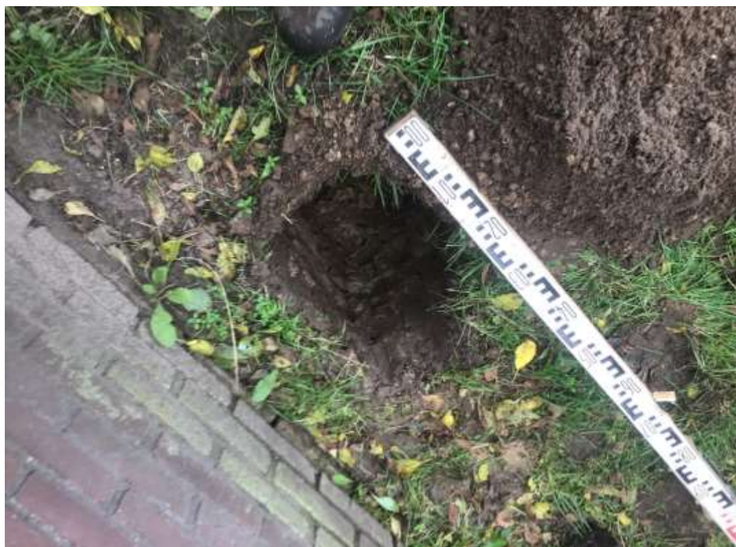
Foto 16: inspectiegat A01 0,2-0,5 m-mv
