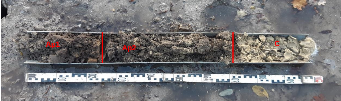
Afbeelding 21: Boring 2 met van links naar rechts de (sub)recent geroerde lagen (Ap1, Ap2) en het dekzand (C).
