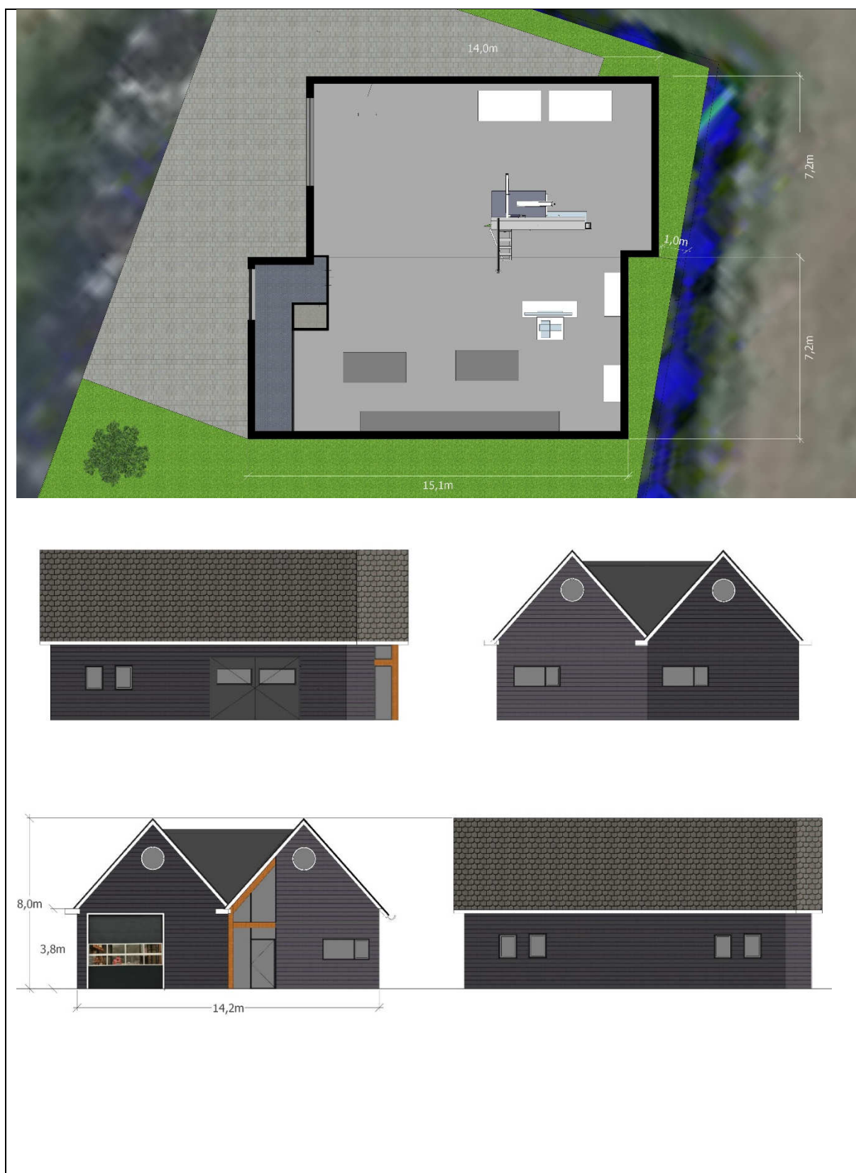
Figuur 2: indeling werkplaats en gevelaanzichten
