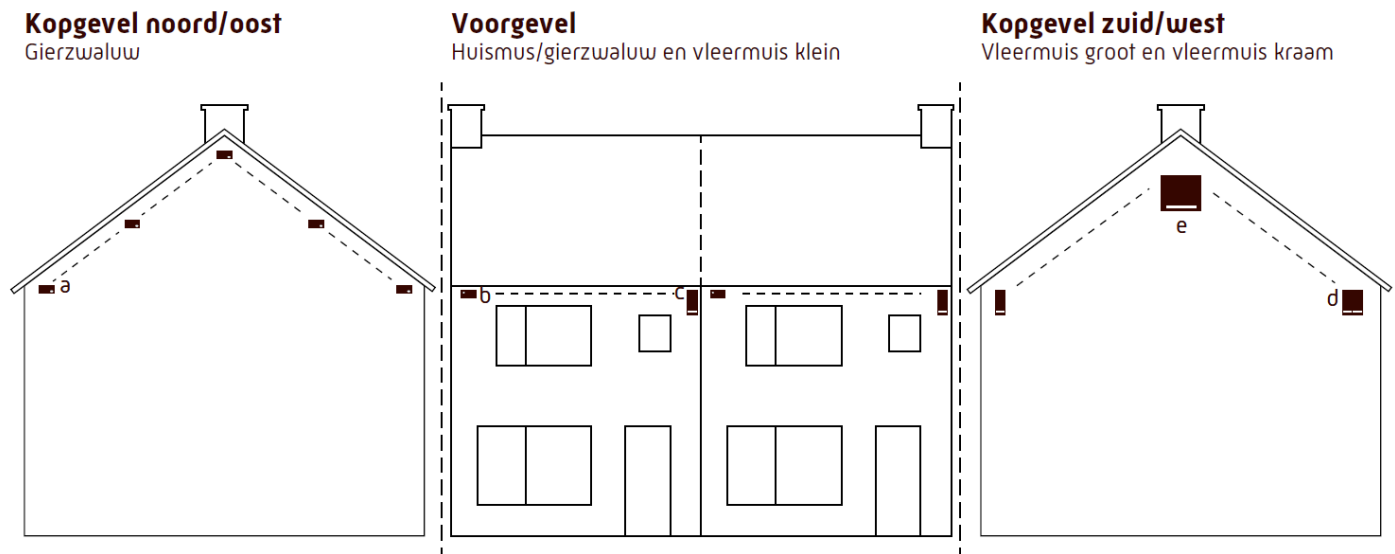
Figuur 11. Positionering van prefab kasten in grondgebonden woningen met a = gierwaluwkast, b = huismuskast, c = kleine zomerverblijfplaats vleermuis, d = grote zomerverblijfplaats vleermuis, e = kraamverblijfplaats vleermuis. Bron: Unitura.
