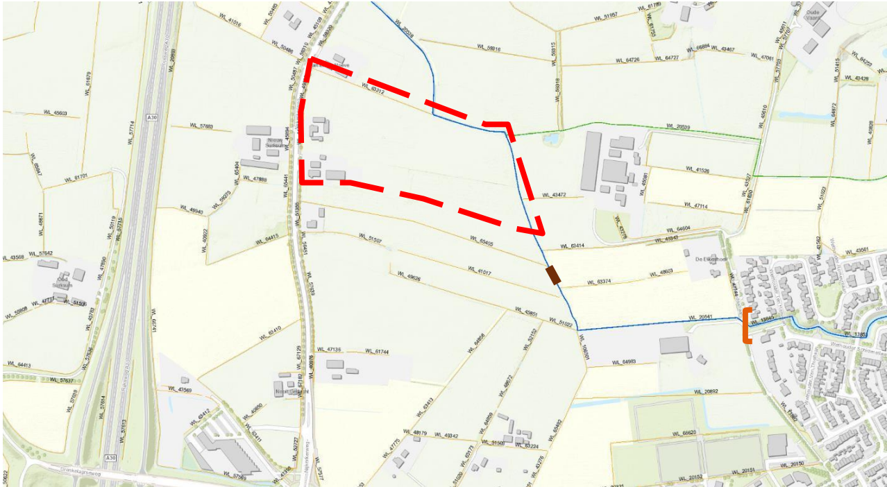
Afbeelding 9 Watersysteem met A-watgangen (donkerblauw), B-watgangen (groen) en C-watgangen (oranje geel). Het plangebied is rood omgeven. De stuw bij de Bloemendaallaan is weergegeven in oranje. Duiker KDU-20533 is weergegeven als donkerbruine lijn.
