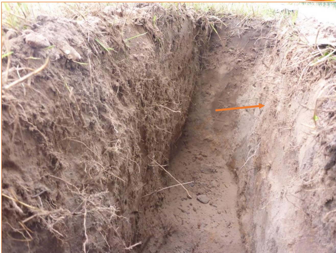
Foto 7: Aanzicht van de profielsleuf met bovenin bij de oranje bijl extensieve beworteling
