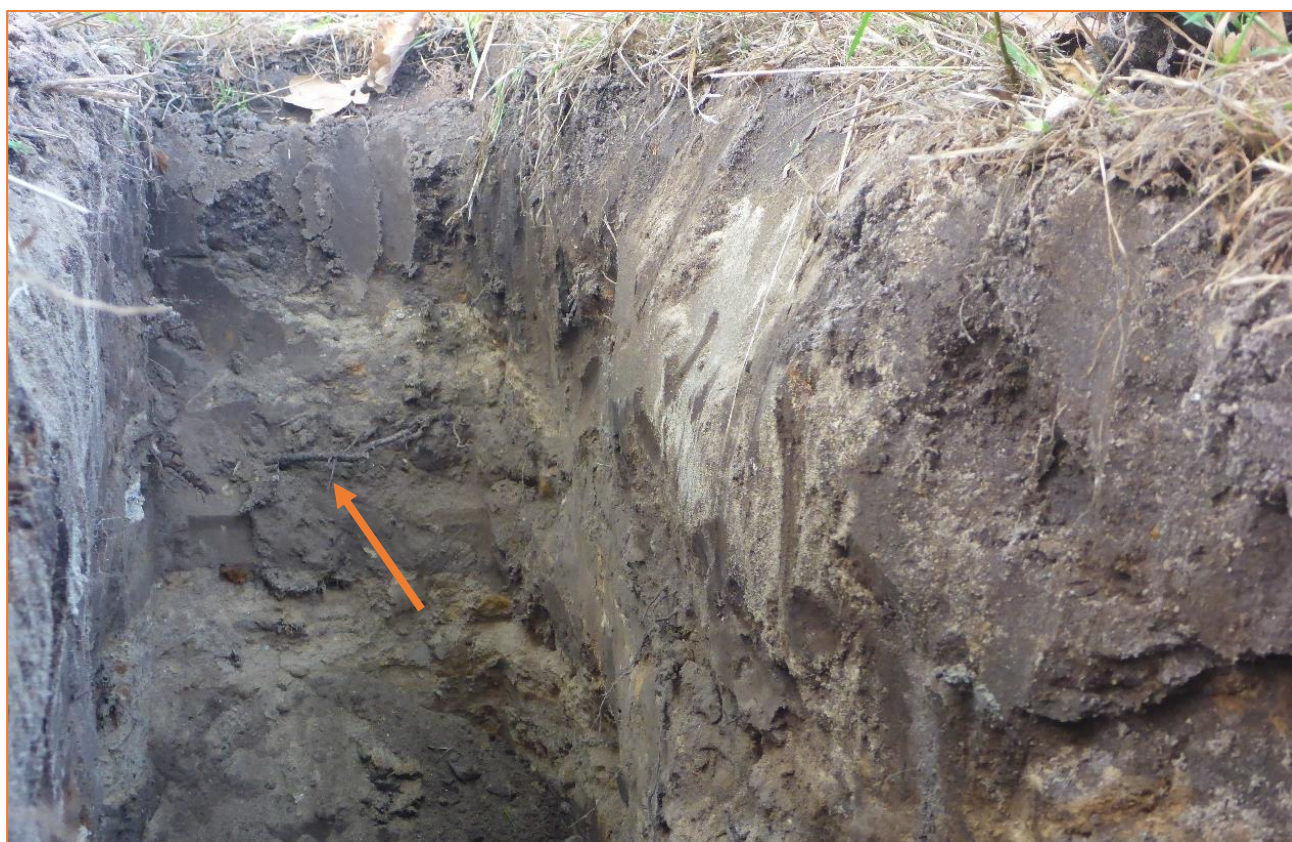
Foto 10: Aanzicht van de profielsleuf met zeer extensieve beworteling (oranje pijl).
