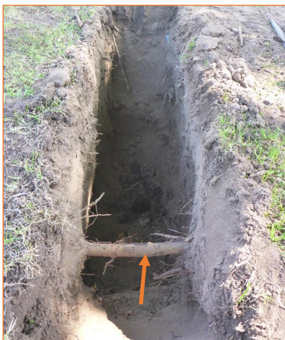
Foto 12: Aanzicht van de profielsleuf met intensieve beworteling bovenin en een wortel van 5 cm dikte (oranje pijl).
