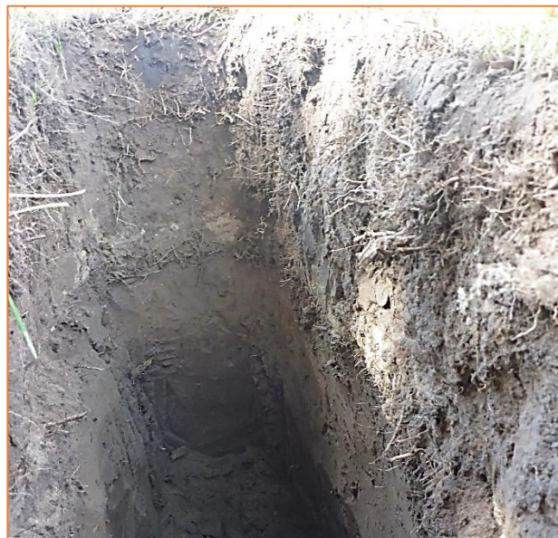
Foto 8 en 9: Locatie van de profielsleuf op 5,85 meter uit de stam bij boom 4. De afstand naar de hoek van het perceel is 5,5 meter. Aanzicht van de profielsleuf met bovenin intensieve beworteling zichtbaar en daaronder afwezigheid van beworteling.
