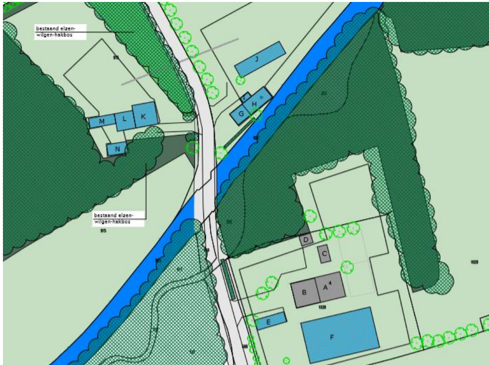
Figuur 1 De verschillende gebouwen zijn aangegeven met de letters A t/m N. De blauwe gebouwen zullen worden gesloopt terwijl de grijze behouden blijven.
