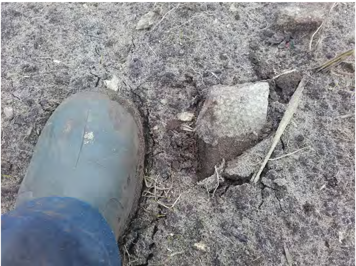
Aangetroffen asbesthoudend materiaal bij boring 336
