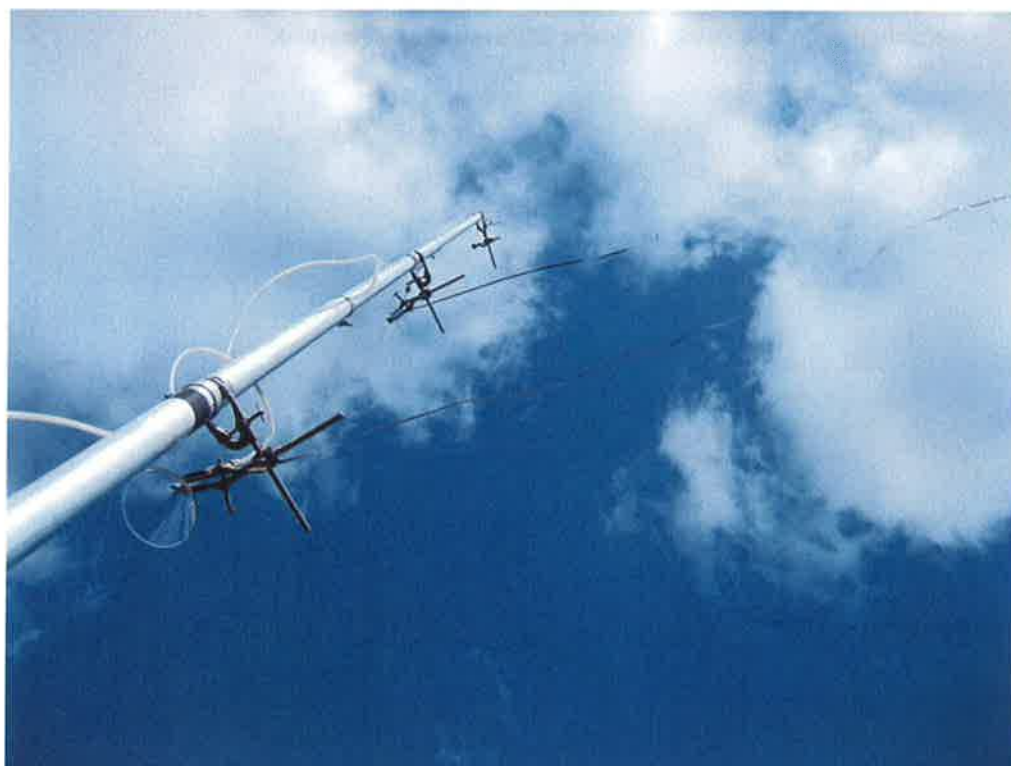
Figuur 4.4. Meetmast met geurtrechters op verschillende hoogten en de lintjes voor de windrichting
