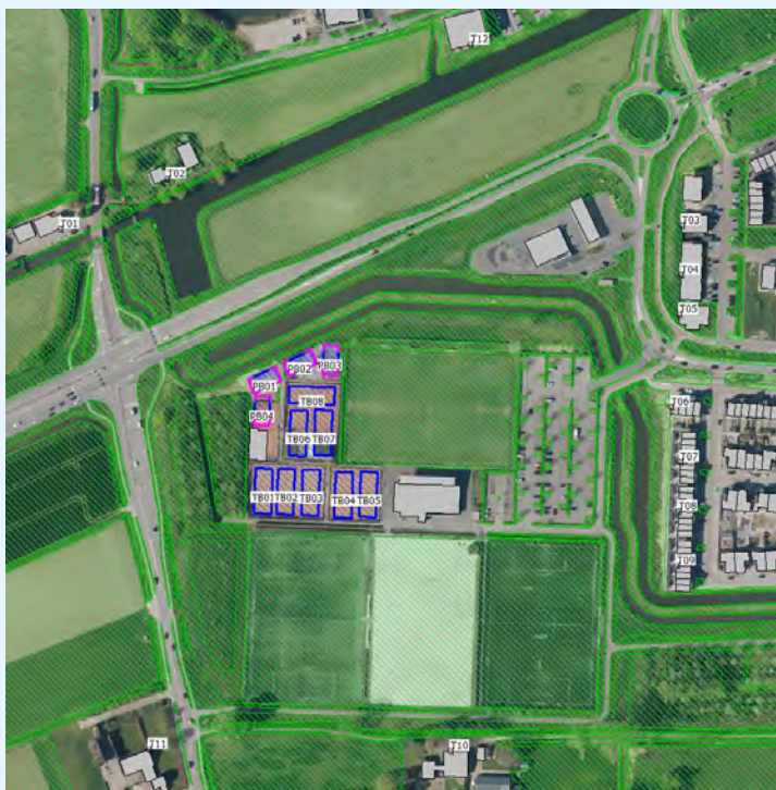
figuur 3: overzicht rekenmodel langtijdgemiddeld beoordelingsniveau ( L_{Ar,LT} ) nieuwe situatie. De gekleurde schuin gestreepte vlakken geven het type bodemgebied (groen = absorberend). De paarse lijnen zijn de glasplaten van de padelbanen. De blauwe vlakken zijn de oppervlaktebronnen van het tennis- en padelspel.
