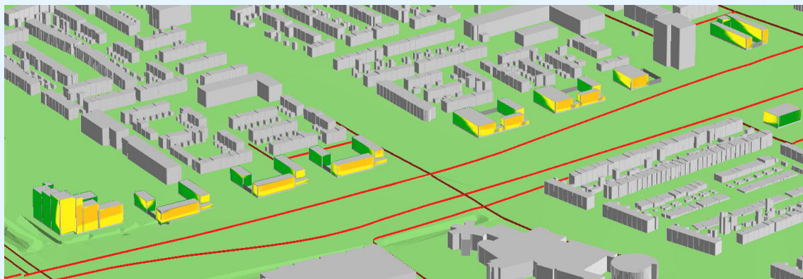
figuur 13: geluidsbelasting ten gevolge van de Nijmeegseweg met SMA-NL8G+ wegdek (inclusief aftrek 5 dB)
