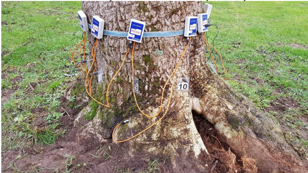
Foto 1. Stamvoet boom 17 tijdens onderzoek met de PiCUS-geluidstomograaf
