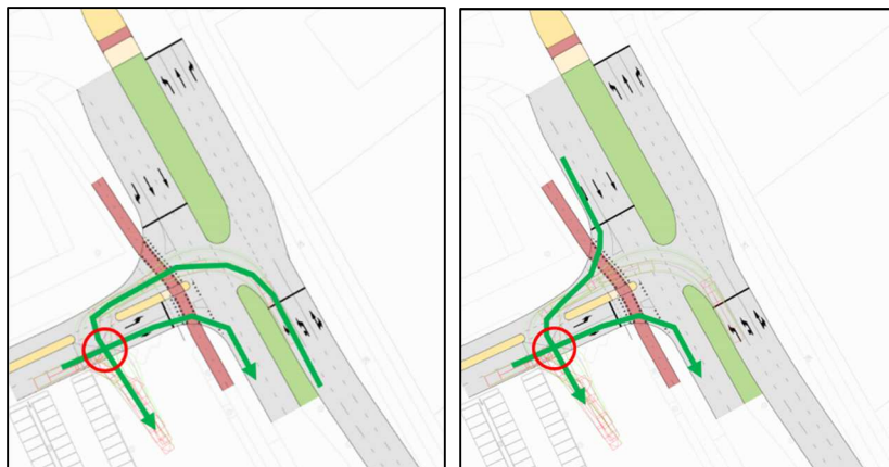
Figuur 2.2: Conflictsituatie door verkeer richting tankstation
