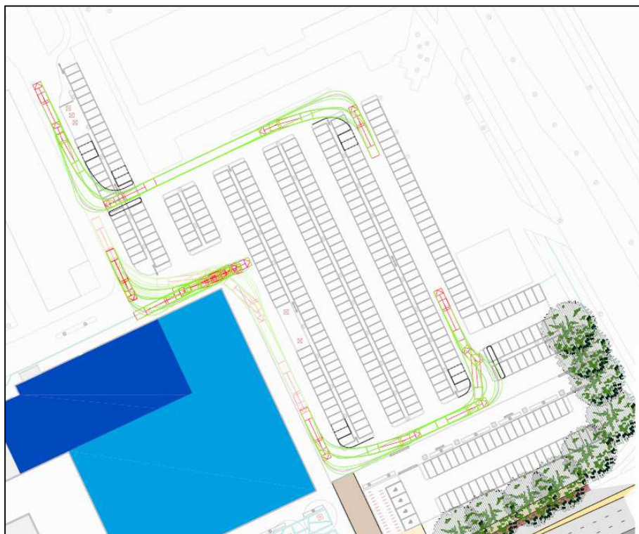
Figuur 2.4: Benodigde manoeuvreerruimte over het parkeerterrein
