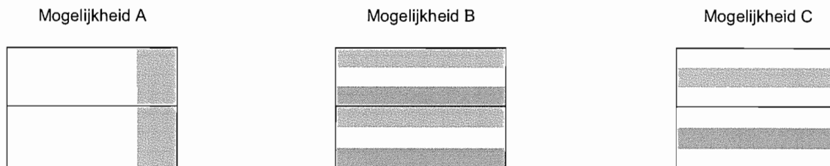
Figuur 1. Drie mogelijkheden voor het nemen van deelmonsters uit asfaltboorkernen die uit verschillende lagen bestaan. De grijs getinte vlakken zijn de gebieden van monstername.
