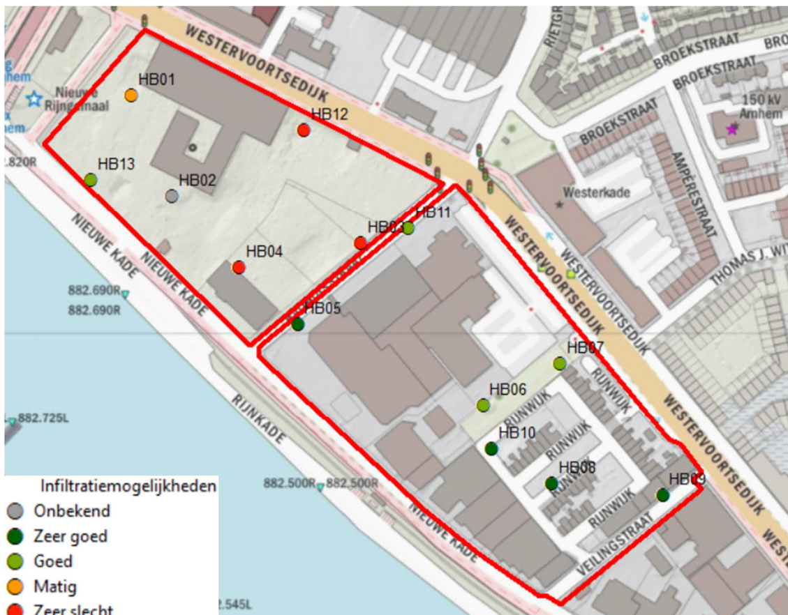
Figuur 3.2 Overzicht infiltratiemogelijkheden
