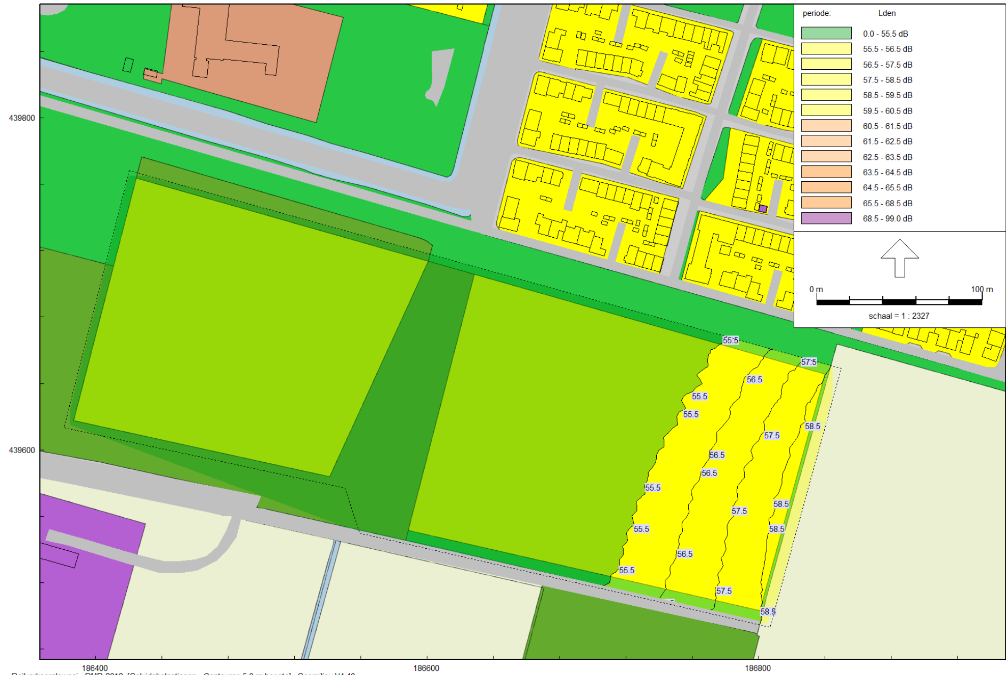
Resultaat geluidscontouren spoorweg op 5,0 meter hoogte (representatief voor verdieping)
