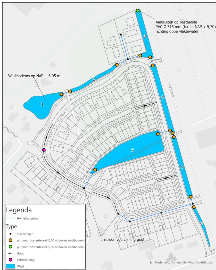
Afbeelding 3.5: Berging en afvoer van hemelwater
