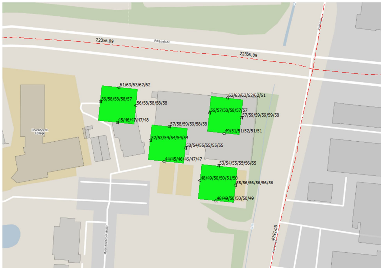
Figuur 4-1 – Ligging Vlijt-torens met per gevel de waarde van het geluid vanwege gemeentewegen in dB
