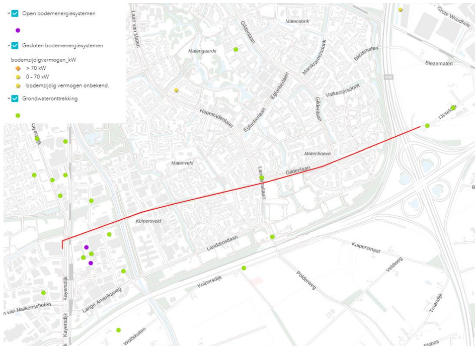
Figuur 5-3: Grondwateronttrekkingen en bodemenergiesystemen in de omgeving van het 150 kV tracé (rood)
