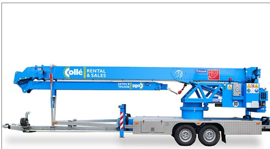
Voorbeeld van een lichte, mobiele kraan. Geschikt voor het aanreiken van o.a. zinken dakplaten en isolatiemateriaal.
