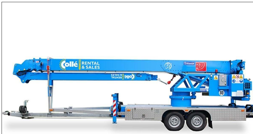
Voorbeeld van een lichte, mobiele kraan. Geschikt voor aanreiken van zinken dakplaten en isolatiemateriaal.
