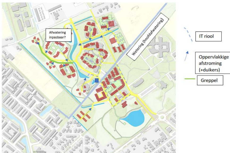
Afbeelding 5.3 Afwateringsstructuur De Wellen met greppel (principe tekening, ondergrond inmiddels verouderd)
