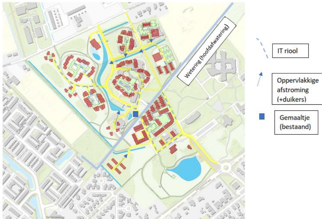
Afbeelding 5.2 Afwateringsstructuur De Wellen zonder greppel (principe tekening, ondergrond inmiddels verouderd)
