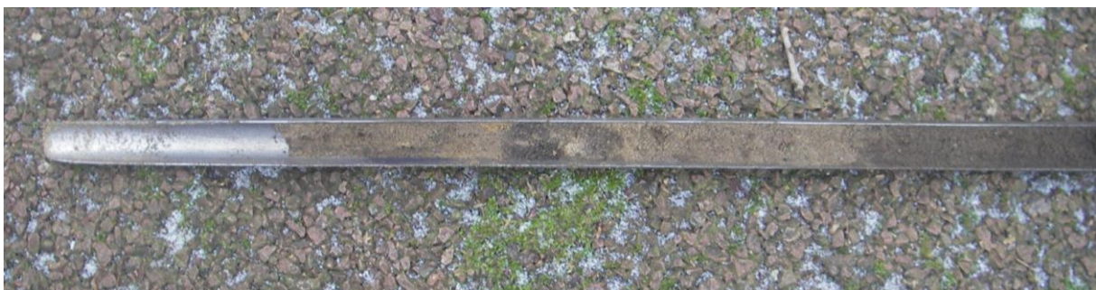
Figuur 13: Foto van de volledig verstoorte bodemopbouw zoals deze onder de tennisbaan is aangetroffen.
