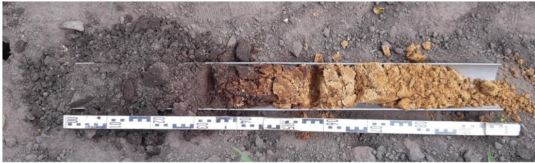
Afbeelding 15: Foto van het boorprofiel van boring 2 met v.l.n.r. de bruingrijze bouwvoor, de bruin/oranje/gele menglaag (A/B/C-horizont) en het lichtgele dekzand met roestvlekken.
