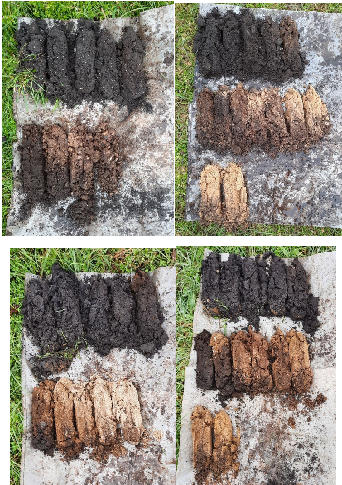
Foto's van boring 1 (linksboven) respectievelijk van 0 tot 80 cm, boring 2 (rechtsboven) respectievelijk van 0 tot 120 cm, boring 3 (linksonder) respectievelijk van 0 tot 100 cm en boring 5 (rechtsonder) respectievelijk van 0 tot 120 cm.
