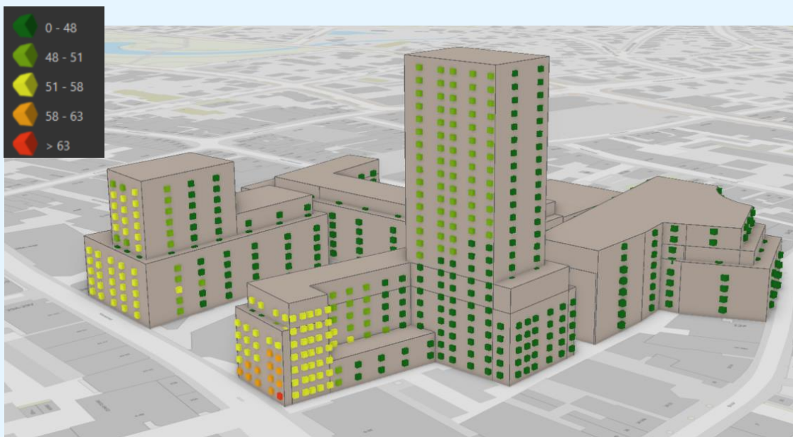
figuur 5: geluidsbelasting op plan ten gevolge van wegverkeer (incl. aftrek) - Zuidoostzijde
