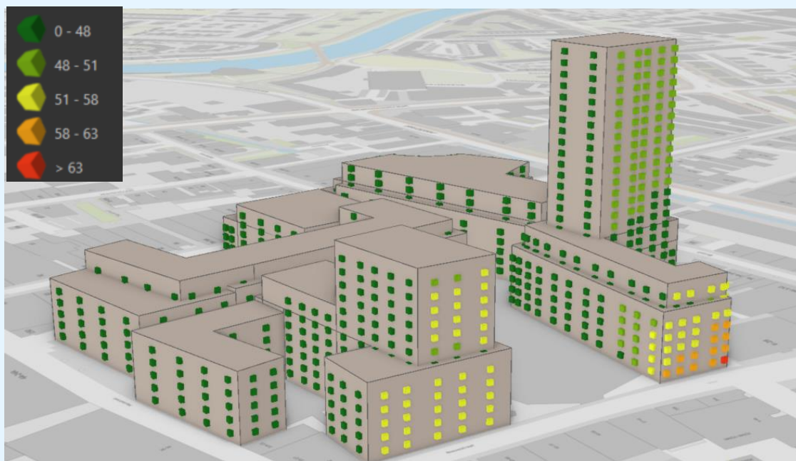
figuur 4: geluidsbelasting op plan ten gevolge van wegverkeer (incl. aftrek) - Zuidwestzijde
