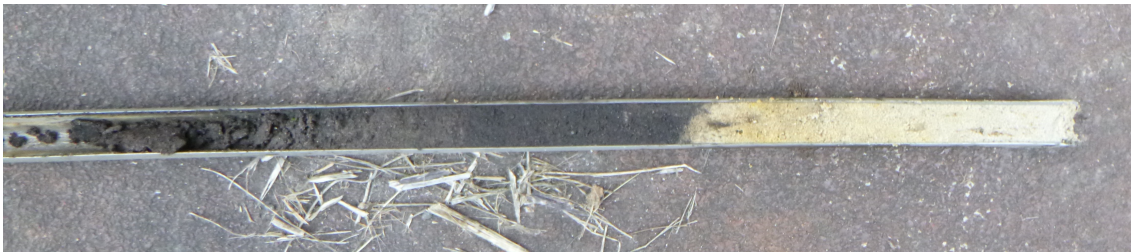
Figuur 8: Beemte, Oude Beemterweg 6: De moerige zandlaag zoals deze op de boorpunten 3, 4, 6 en 7 is aangetroffen tussen de toplaag (links) en de C-horizont (rechts).
