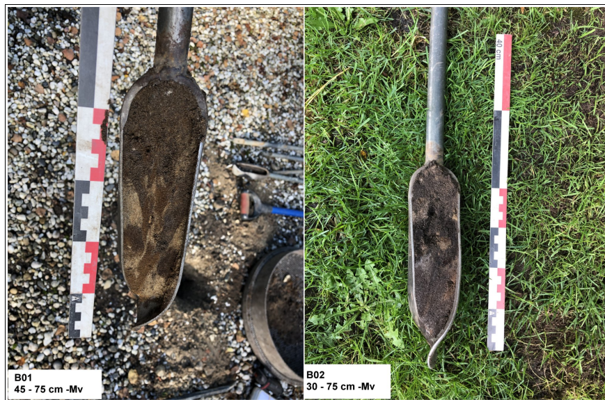
Figuur 13. Beekbergen, Stoppelbergweg 63: Resultaten booronderzoek. In de boringen 1 en 2 zijn restanten van bodemhorizonten waargenomen van een niet meer intacte podzolbodem.
