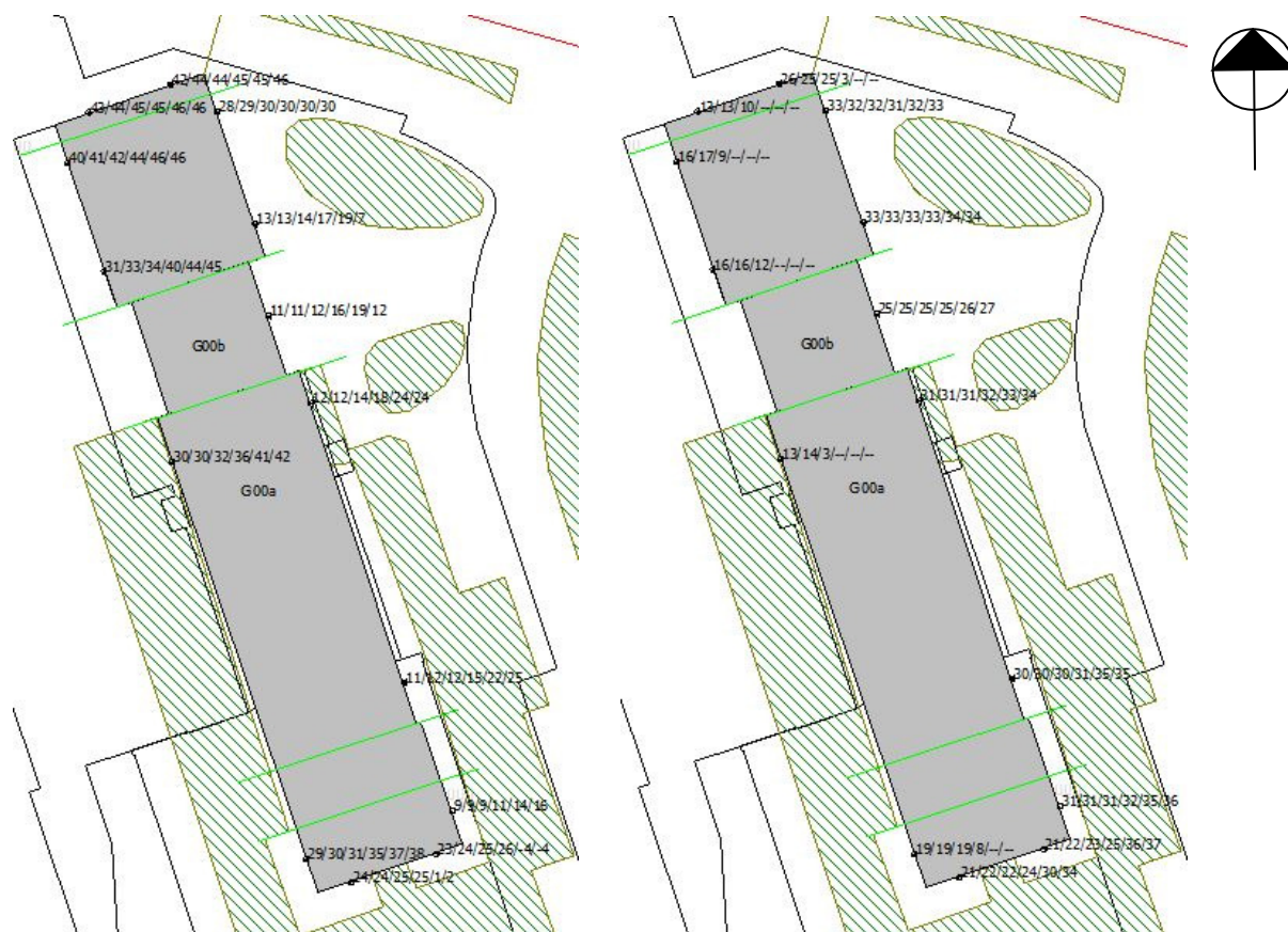
Figuur 5.3/5.4 Geluidbelasting Sprengenweg/Wil. Druckerstraat in dB L den (incl. correctie 5 dB)
