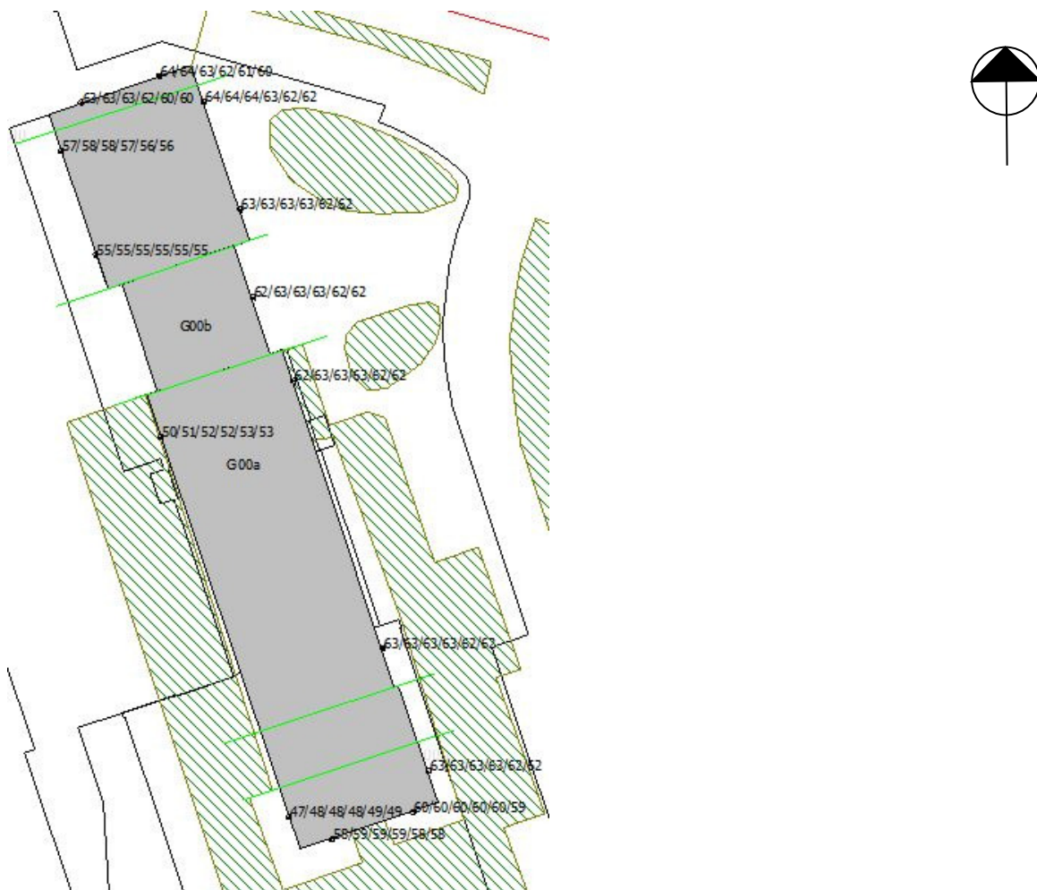
Figuur 5.6 Geluidbelasting vanwege wegverkeerslawaaai in dB Lden (excl. correctie)
