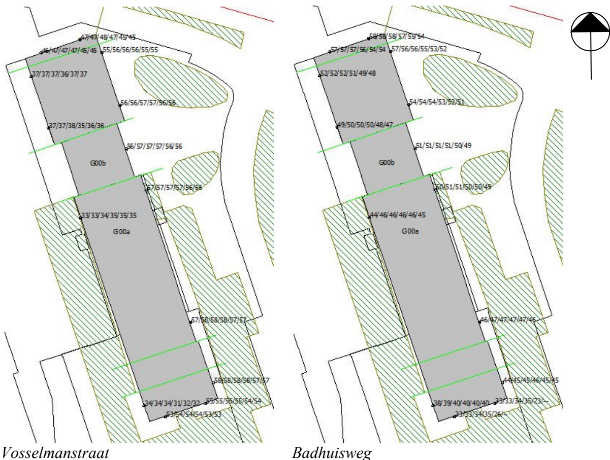
Figuur 5.1/5.2 Geluidbelasting Vosselmanstraat/Badhuisweg in dB L den (incl. correctie 5 dB)
