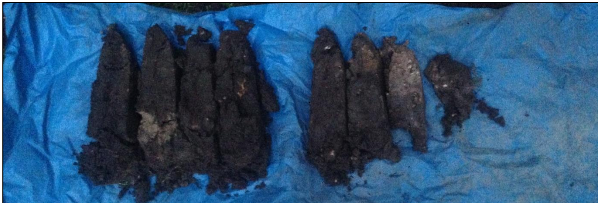
Boring 1: 0-100 cm -Mv. Gestaakt in grindpakket, materiaal loopt uit boor.
