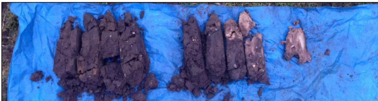
Boring 2: 0-110 cm -Mv. Gestaakt in grind, materiaal loopt uit boor.
