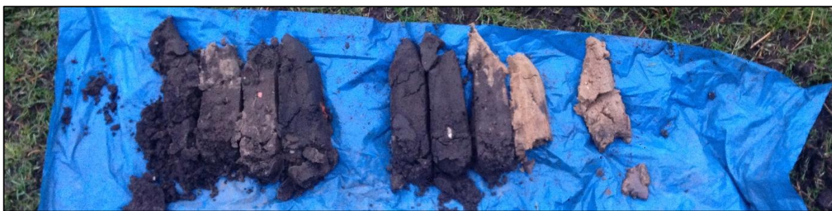
Boring 5: 0-110 cm -Mv. Materiaal loopt uit boor.
