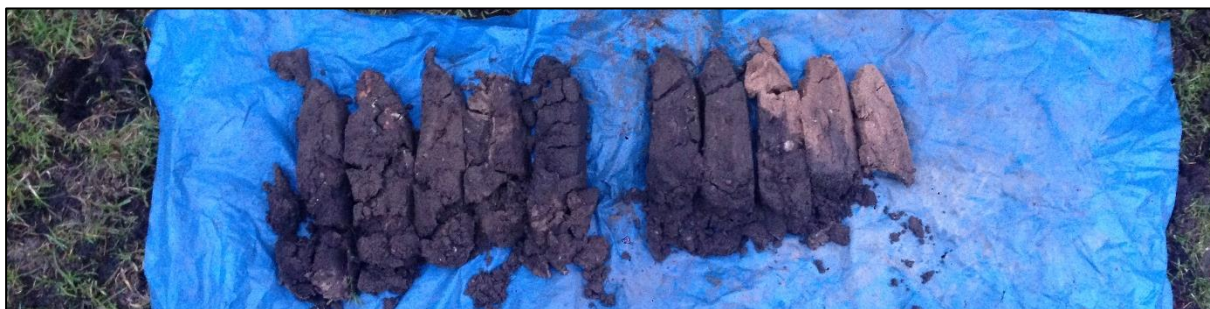
Boring 3: 0-100 cm -Mv. Gestaakt in grind, materiaal loopt uit boor.
