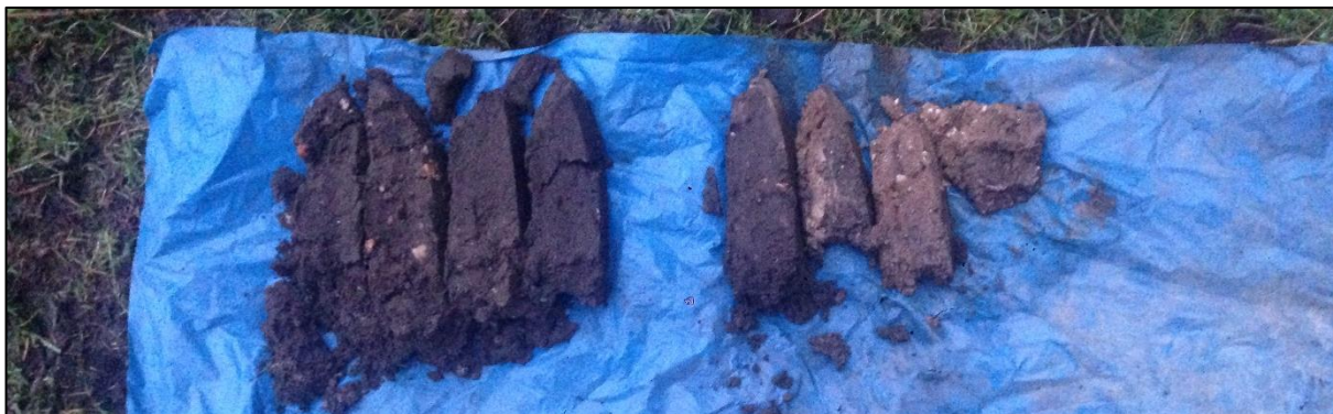
Boring 4: 0-100 cm -Mv. Gestaakt in grind, materiaal loopt uit boor.
