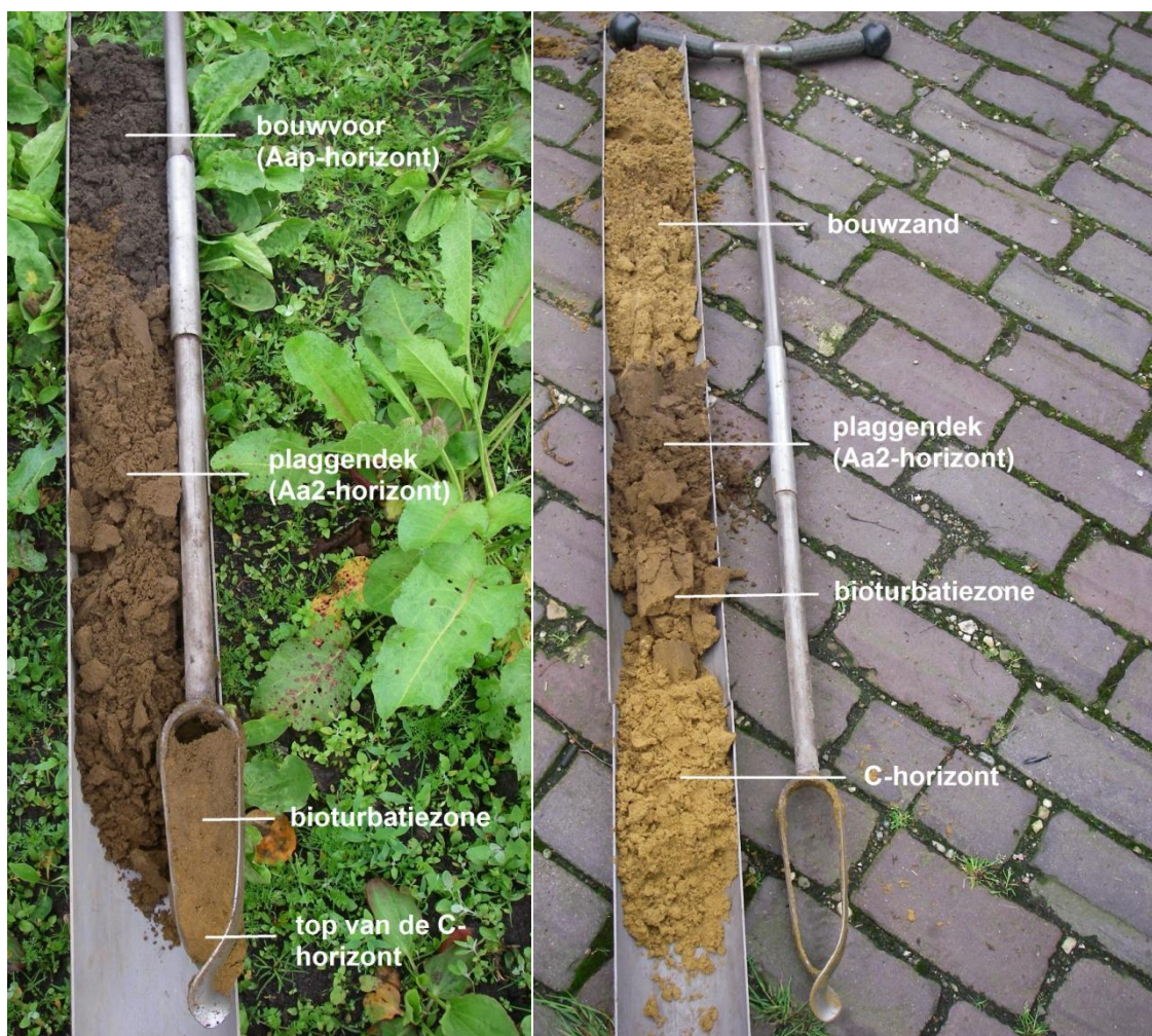
Fig. 3.1: Het opgeboorde sediment van boring 4 (links) en van boring 2 (rechts).
