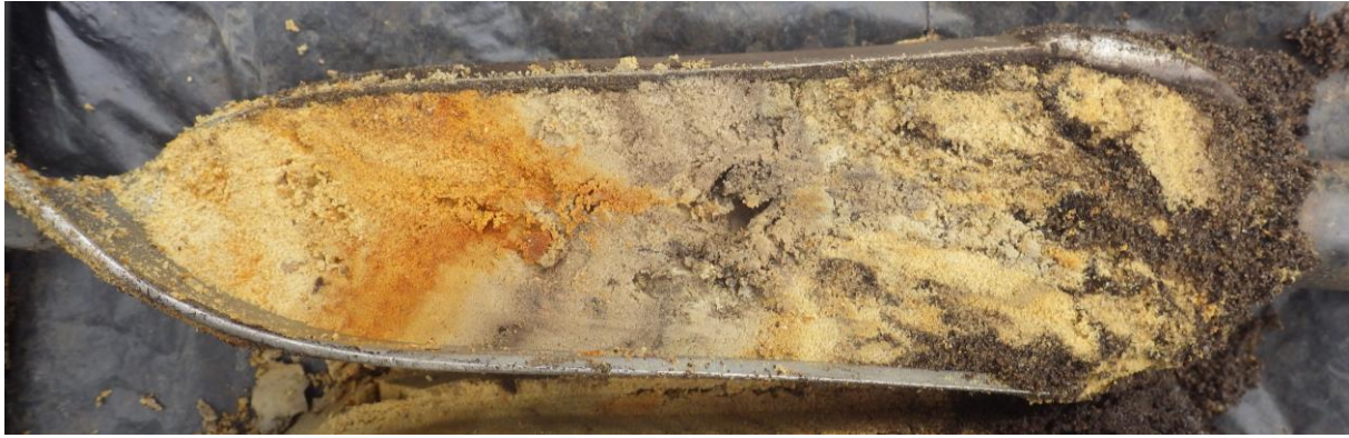
Boring 3: sequentie van zeer- tot uiterst fijn sterk siltig zand, sterk zandige leem en zeer fijn sterk siltig zand met gleyverschijnselen, tussen 45 en 55 cm -Mv
