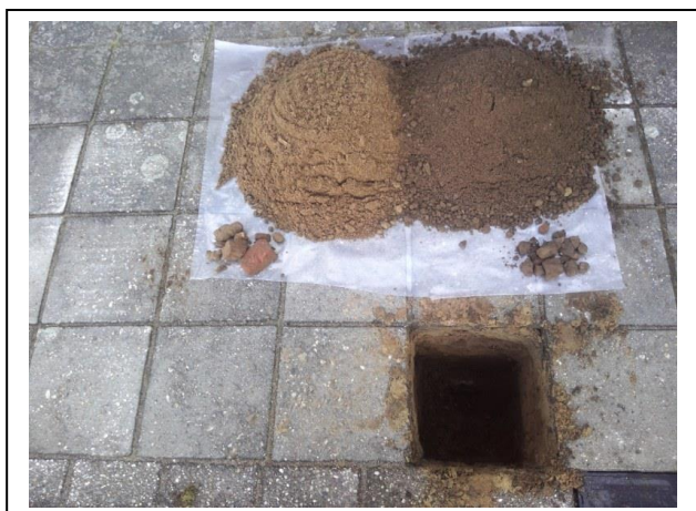
Foto 1. Opgegraven en gezeefd materiaal inspectiegat 01A
