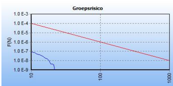
Figuur 6 FN-curve van de kilometer met de hoogste overschrijdingsfactor van gastransportleiding N-567-20 in de huidige situatie. De ligging van deze kilometer is hiernaast in het rood weergegeven op een topografische kaart.
