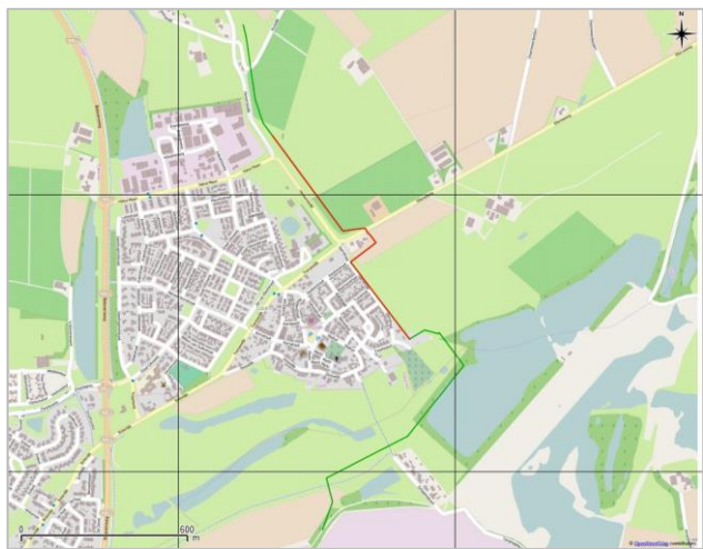
Figuur 5 Overschijding van het groepsrisico als functie van de stationing van de N-567-20.
