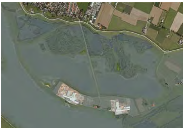
Figuur 50 Bij 14.50 m +NAP (waarop de gehele uiterwaard overstroomt over de Geitenwaardsedam)
