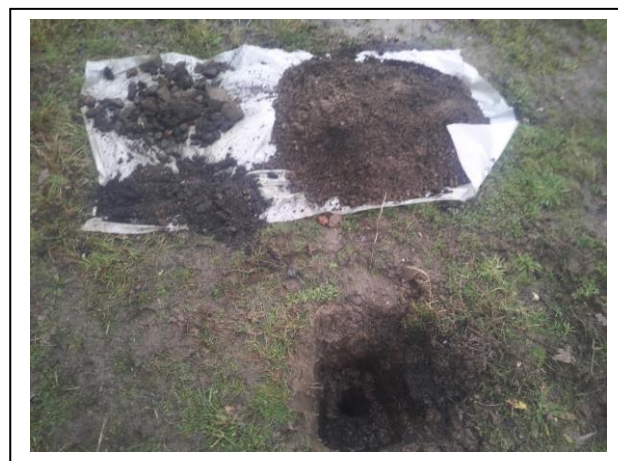
Foto 4. Opgegraven en gezeefd materiaal asbestinspectiegat D04
