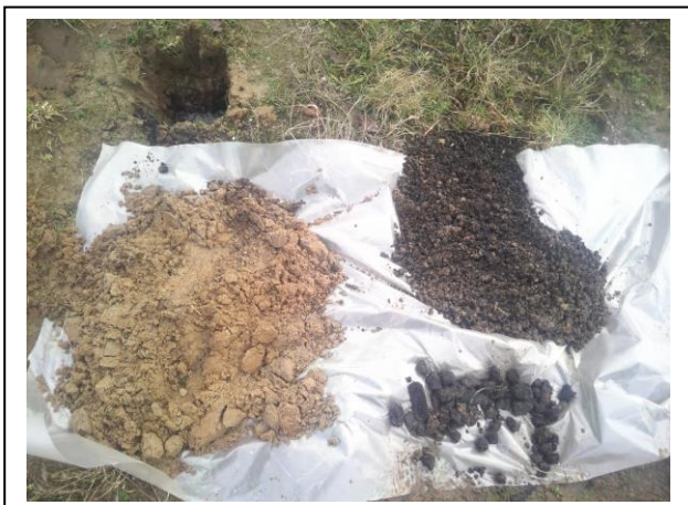
Foto 9. Opgegraven en gezeefd materiaal asbestinspectiegat D09
