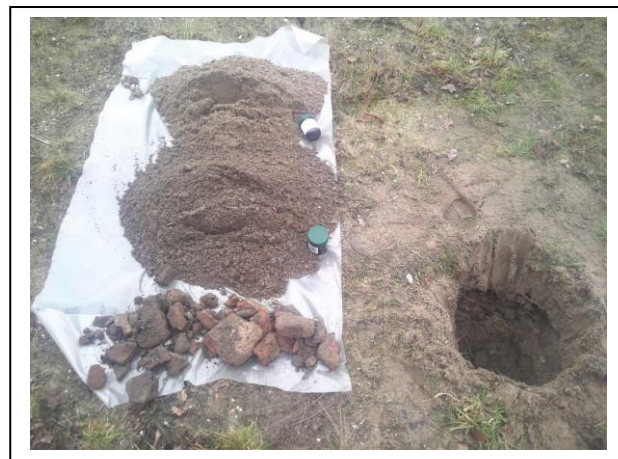
Foto 6. Opgegraven en gezeefd materiaal asbestinspectiegat D06
