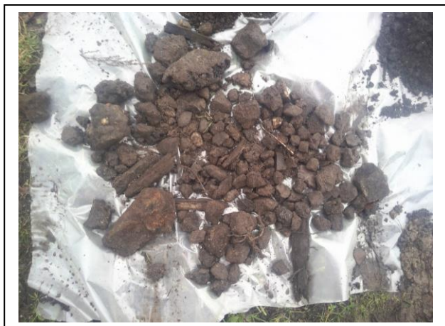
Foto 5. Opgegraven en gezeefd materiaal asbestinspectiegat D05
