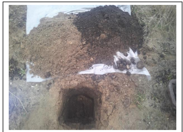
Foto 10. Opgegraven en gezeefd materiaal asbestinspectiegat D10
