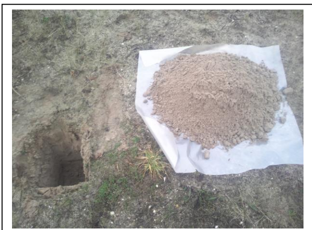
Foto 17. Opgegraven en gezeefd materiaal asbestinspectiegat D17
