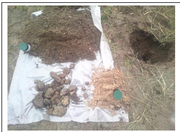
Foto 3. Opgegraven en gezeefd materiaal asbestinspectiegat D03
