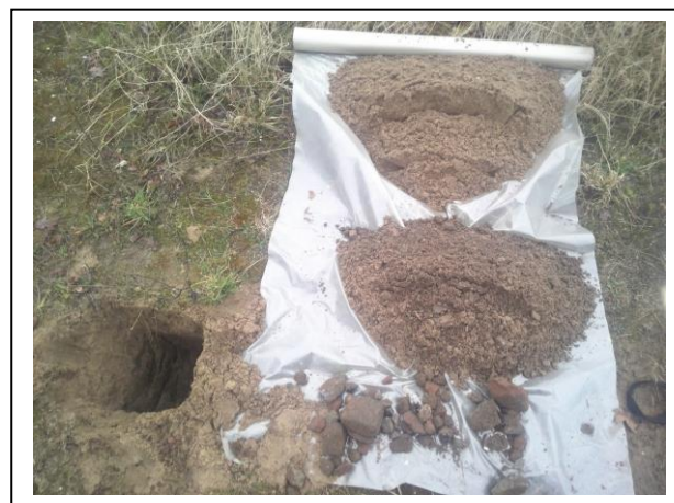
Foto 18. Opgegraven en gezeefd materiaal asbestinspectiegat D18
