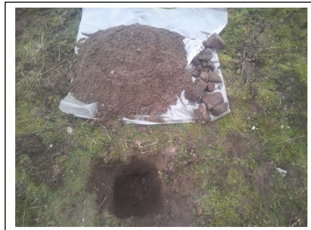
Foto 14. Opgegraven en gezeefd materiaal asbestinspectiegat D14
