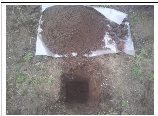
Foto 15. Opgegraven en gezeefd materiaal asbestinspectiegat D15
