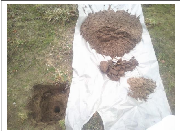
Foto 7. Opgegraven en gezeefd materiaal asbestinspectiegat D07
