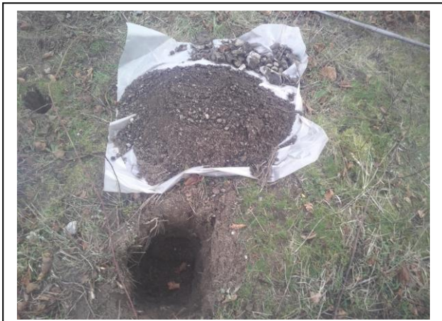
Foto 13. Opgegraven en gezeefd materiaal asbestinspectiegat D13
