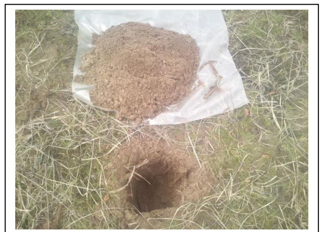
Foto 12. Opgegraven en gezeefd materiaal asbestinspectiegat D12
