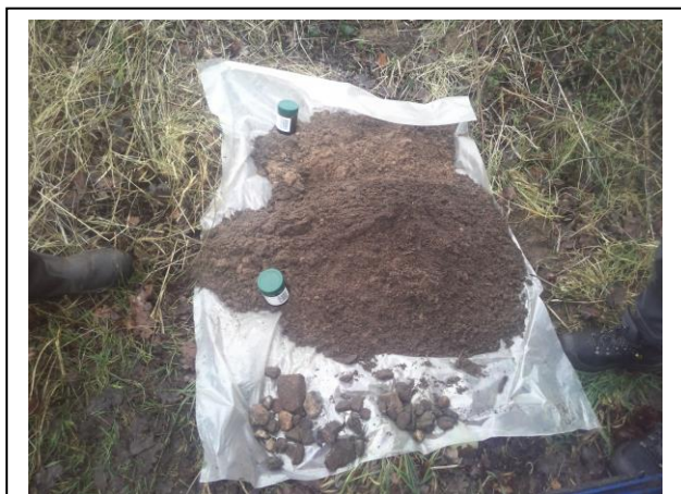
Foto 1. Opgegraven en gezeefd materiaal asbestinspectiegat D01
