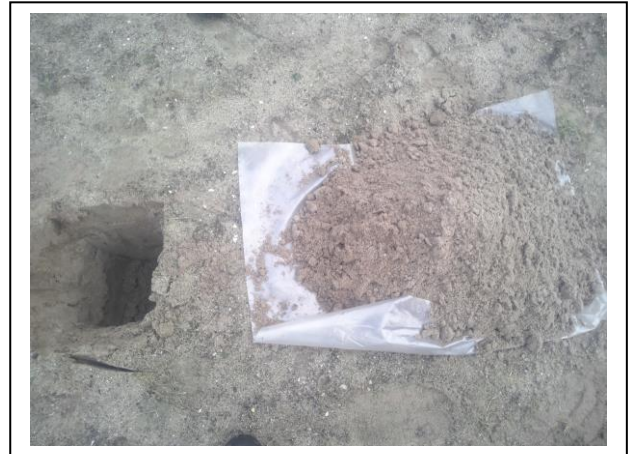
Foto 8. Opgegraven en gezeefd materiaal asbestinspectiegat D08
