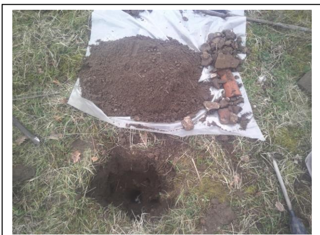
Foto 11. Opgegraven en gezeefd materiaal asbestinspectiegat D11
