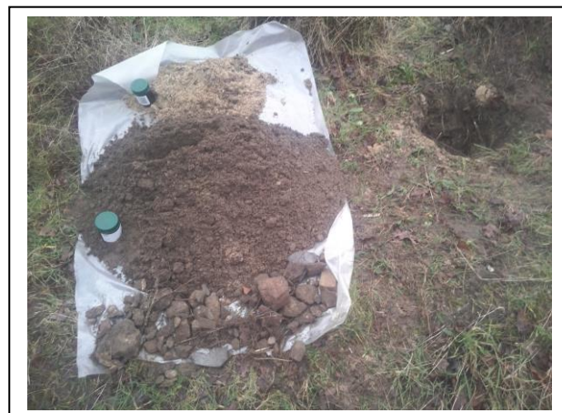
Foto 2. Opgegraven en gezeefd materiaal asbestinspectiegat D02
