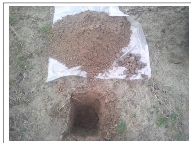
Foto 16. Opgegraven en gezeefd materiaal asbestinspectiegat D16
