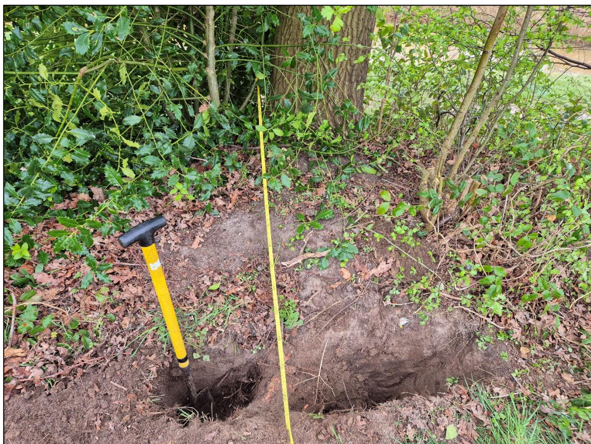
Afbeelding 16; Overzicht gegraven profiel op 1.5 tot 1.8 meter uit het hart van de stamvoet, haaks op de ontwikkelrichting van wortels.
