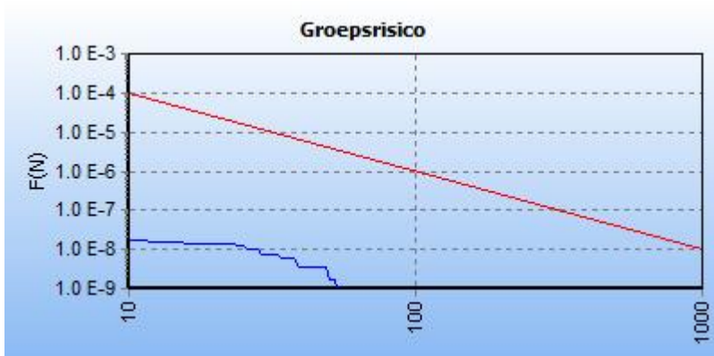
5.2 Figuur 5.7 FN curve voor 9581_leiding-N-570-20-deel-1 van N.V. Nederlandse Gasunie voor de kilometer tussen stationing 120.00 en stationing 1120.00
