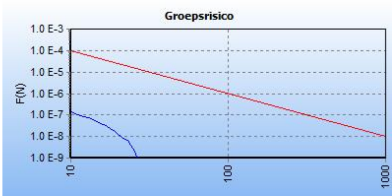
5.2 Figuur 5.7 FN curve voor 9581_leiding-N-570-20-deel-1 van N.V. Nederlandse Gasunie voor de kilometer tussen stationing 120.00 en stationing 1120.00
