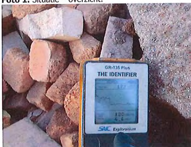
Foto 3. Dosistempo oppervlak vuurvaste stenen
