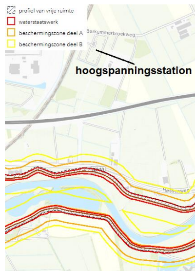
Figuur 3 Legger waterkering WDOD
