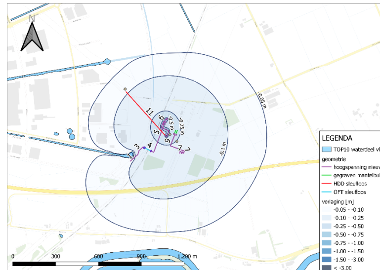
Figuur 7 Verlaging grondwaterstand fase 2 op t=28d
