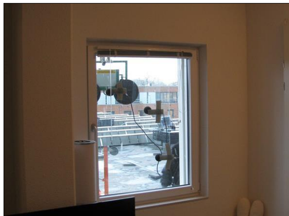
Foto II.2 Aanzicht microfoonposities in spouw
