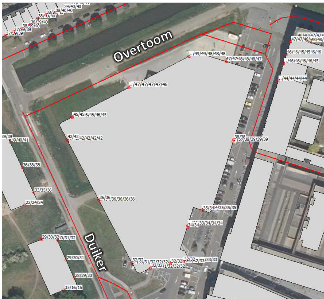
Figuur 4-2 Geluidbelasting vanwege de nieuwe Overtoom op de geplande woningen in de noord-variant (niet gekoppeld). Geluidbelasting is inclusief correctie artikel 3.4 RMG 2012.
