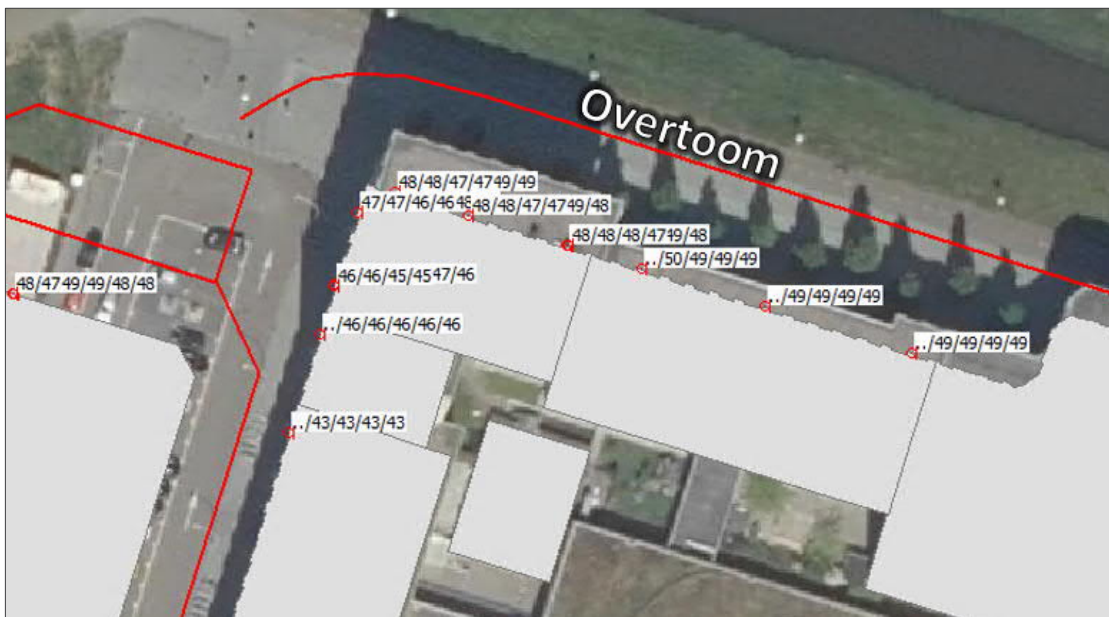
Figuur 4-3 Geluidbelasting vanwege de nieuwe Overtoom op bestaande woningen in de noordvariant (niet gekoppeld). Geluidbelasting is incl. correctie artikel 3.4 RMG 2012.
