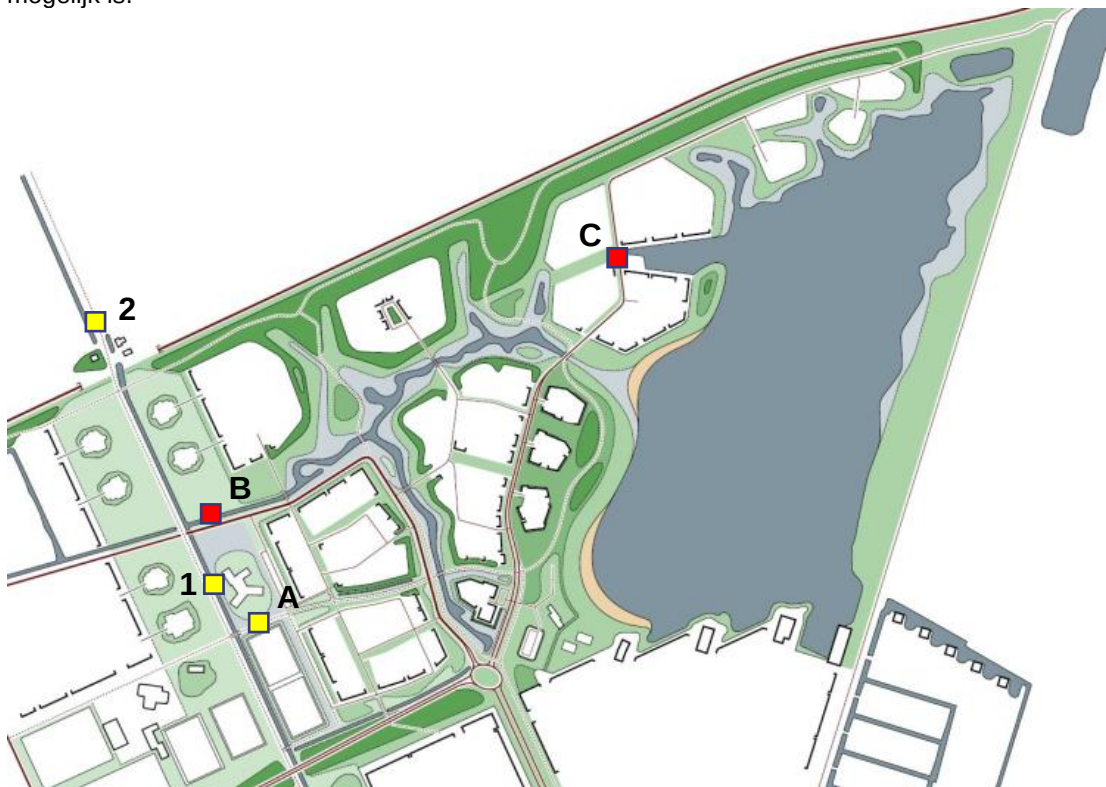
Figuur 1.6 Stuwlocaties (geel = bestaand; rood = nieuw/toekomstig)
