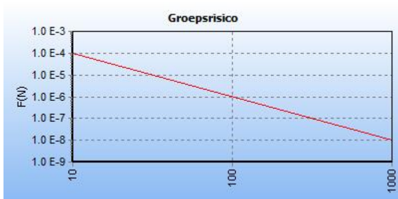
5.5 Figuur 5.5 FN curve voor 5399_leiding-N-570-23-deel-1 van N.V. Nederlandse Gasunie voor de kilometer tussen stationing 0.00 en stationing 860.00
