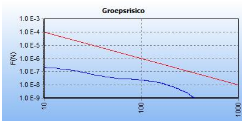
5.5 Figuur 5.5 FN curve voor 5399_leiding-N-570-23-deel-1 van N.V. Nederlandse Gasunie voor de kilometer tussen stationing 0.00 en stationing 860.00
