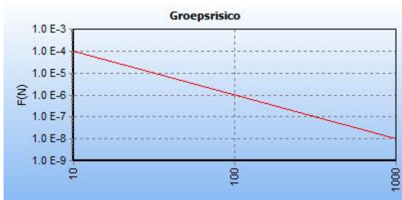
5.4 Figuur 5.4 FN curve voor 5399_leiding-N-570-20-deel-1 van N.V. Nederlandse Gasunie voor de kilometer tussen stationing 1530.00 en stationing 2530.00
