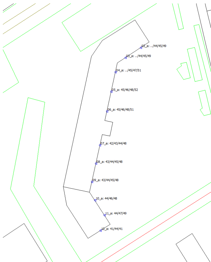
Figuur 3: Rekenresultaten A28 Definitief Ontwerp, inclusief aftrek art. 110g Wgh
