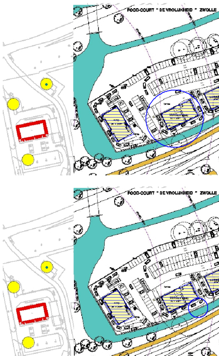
Figuur 7. LFL-contour op verschillende tijdstippen na instantane uitstroming
